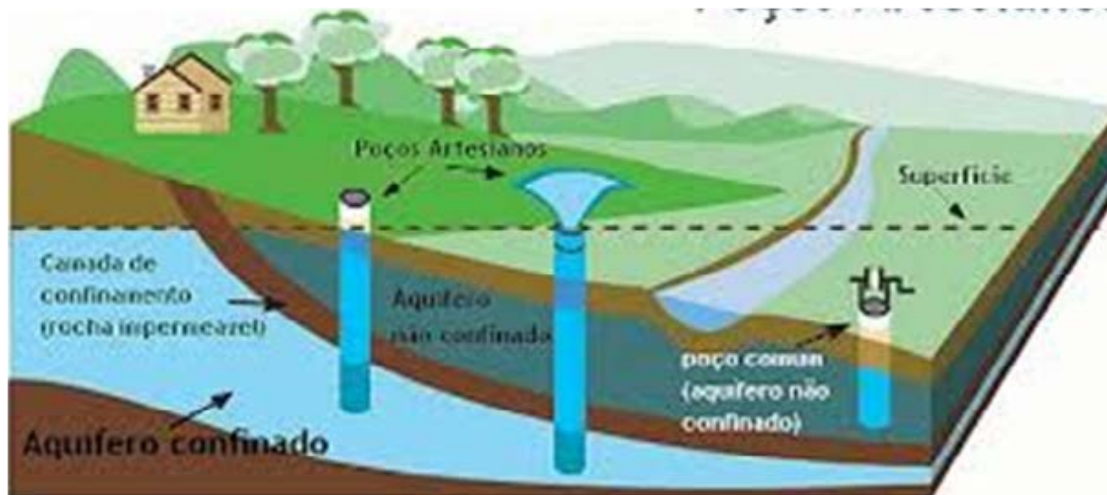
FIGURA 3: EXEMPLO DE SOLUÇÃO INDIVIDUAL DE ABASTECIMENTO DE ÁGUA POR POÇO ARTESIANO. 10
