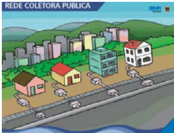
FIGURA 4: SISTEMA COLETIVO DE ESGOTAMENTO SANITÁRIO 18
