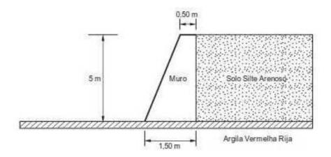
Considerando que o muro acima possui extensão de 17,50 metros, calcule o volume de concreto necessário para sua execução.
