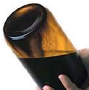
Óleo térmico mineral degradado
