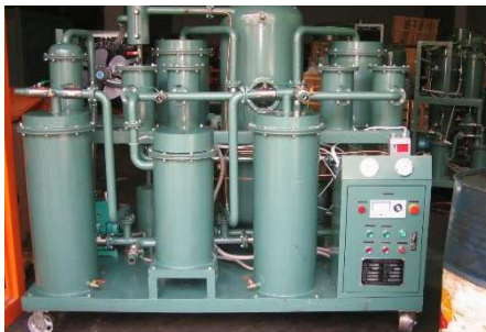
Equipamento portátil de filtragem de óleo hidráulico. (foto: divulgação)
