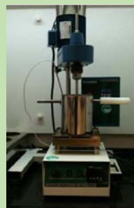
Teste de saponificação (aquecedor, termômetro, agitador)
