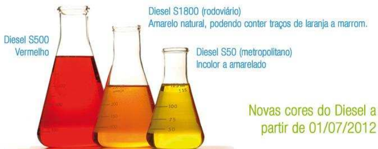
Coloração do diesel rodoviário (Fonte: ANP)
