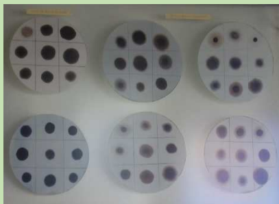
Teste de pingo para determinar a existência de contaminantes leves (percolação em papel semipermeável)
