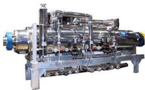
Equipamento utilizado para tratamento contínuo de óleo de corte. (foto: divulgação)
