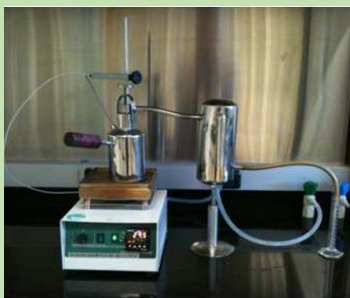
Equipamento para determinação do teor de água e leves por destilação simples à pressão atmosférica e temperatura de 280°C. (aquecedor, termômetro, condensador)
