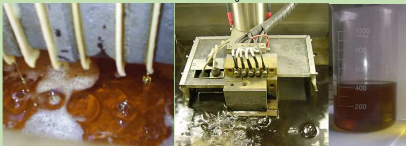
Óleo isolante mineral degradado
